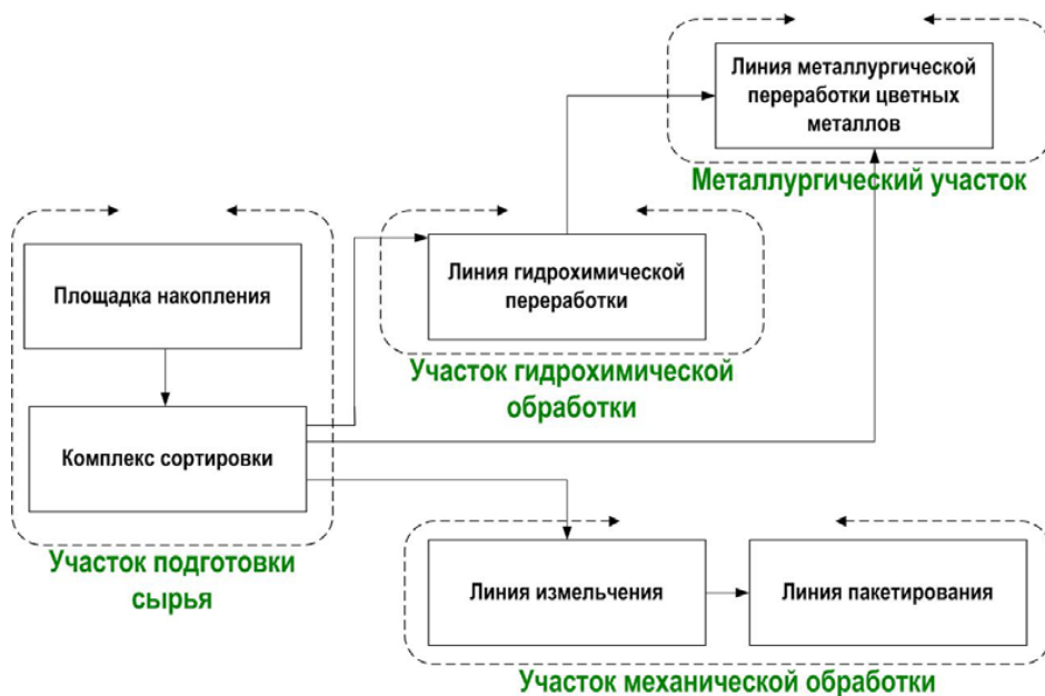
Рис. 3.2. Структура производственных участков вертикально-диверсифицированного промышленного комплекса переработки металлического лома
